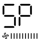
Lorsque l'unité de climatisation s'éteint, passez à la fonction de consultation de température, appuyez sur « v » ou « ^ » pour sélectionner SP, appuyez sur « Confirmer » pour ajuster la valeur de pression statique.
