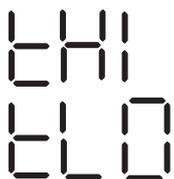
Lorsque l'unité de climatisation s'éteint, passez à la fonction de consultation de température, appuyez sur «  $\vee$  » ou «  $\wedge$  » pour sélectionner tHI ou tLo. Appuyez sur « Confirmer » pour accéder à l'état de réglage, appuyez sur «  $\vee$  » ou «  $\wedge$  » pour sélectionner la température, puis appuyez sur « Confirmer » pour la compléter.
